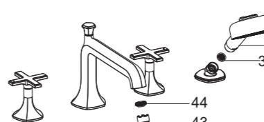
打开主供水源，检查渗漏。打开冷热水阀，使水流过出水嘴，去除杂质。切换到手持花洒，去除杂质，清洗垫片(38)，关闭阀。重新装回起泡器及手持花洒。
